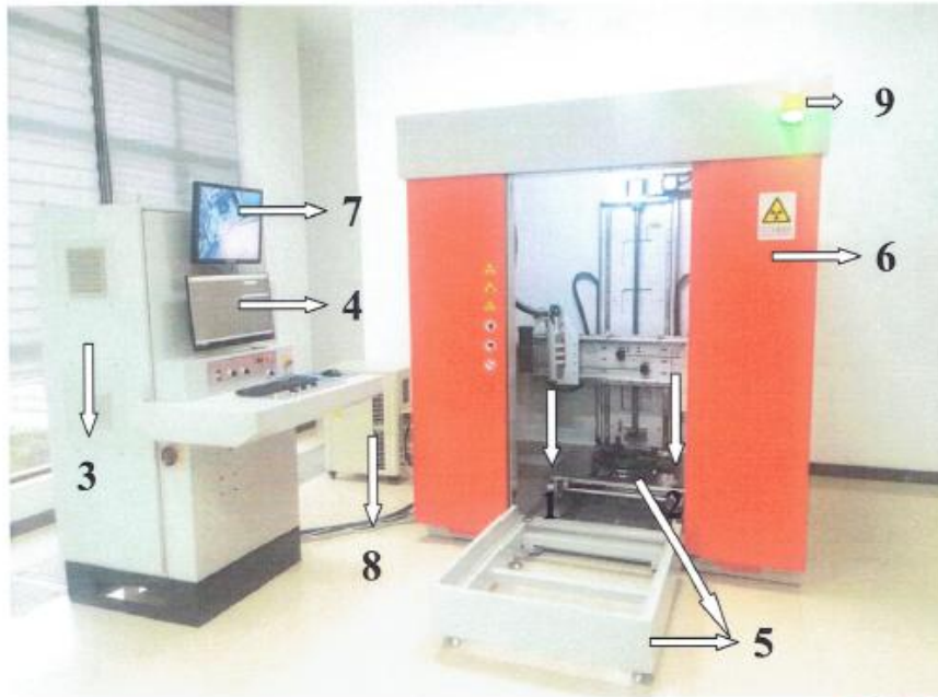
无损检测设备结构组成图
