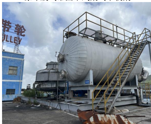
涂布废气甲苯回收装置：冷凝+活性炭吸附+脱附-冷凝回收+催化燃烧
