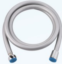
YSG002 PVC 内网纹淋浴管 PVC interior net shower pipe 直径 Diameter Ø13-Ø15mm 规格 Specification F1/2xF1/2x(1.2-2m)
