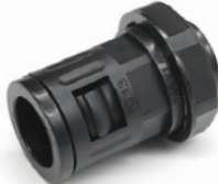
名称: 波纹管快速接头 型号: AD13 M18×1.5 尺寸: 螺纹外径 17.9mm 长 38mm
