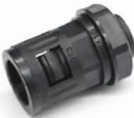
名称: 波纹管快速接头 型号: AD13 M16×1.5 尺寸: 螺纹外径 15.4mm 长 35mm
