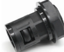
名称: 波纹管快速接头 型号: AD13 M20×1.5 尺寸: 螺纹外径 19.23mm 长 35mm
