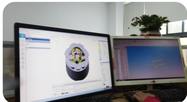
我公司研发团队中有20年以上设计经验设计师1名，大专且有10年设计经验人员3名，专业设计本科人员2名，专科且有5年设计经验人员3名；同时为坚持理论与实践相结合，2016年-2017年先后引进2套德国QForm模拟挤压设备，通过系统模拟可把握模具100%成形度及控制铝的流量流速和壁厚尺寸，再与灵活的设计经验互相结合从而为客户研发生产高难度铝型材提供技术支撑。
