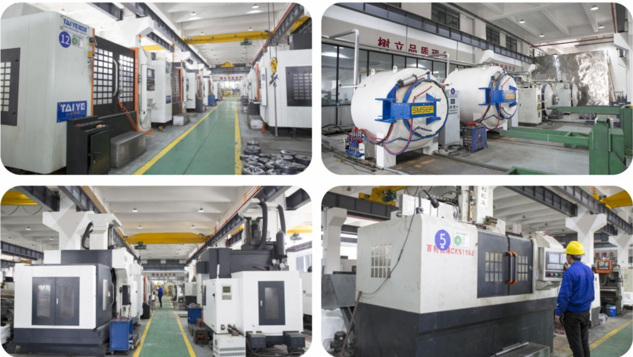
我公司配备有国内最先进真空气淬炉，进口640、540、430、320型慢走丝共8台，切割型腔最大可加工模具满足7500吨机型，970CNC及龙门铣精铣分流孔、精雕工作带都可满足大挤压机模具需要，最大加工模具直径可达1米。我公司引进配备以上精密加工设备旨在保证双孔模具精铣分流孔偏差±0.05MM以内，模具壁厚±0.01MM以内，从而保证模具技术达到行业最优。
