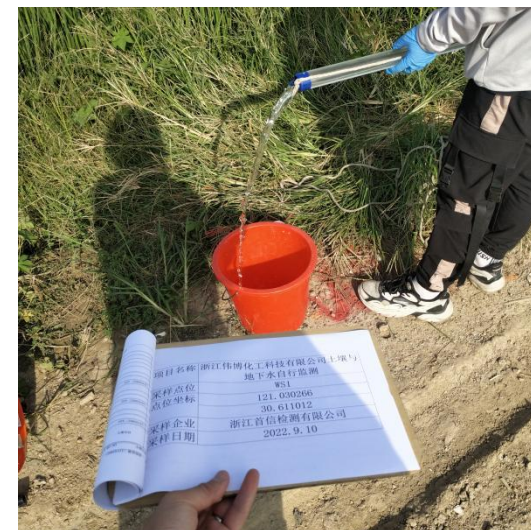
照片9: 现场洗井
