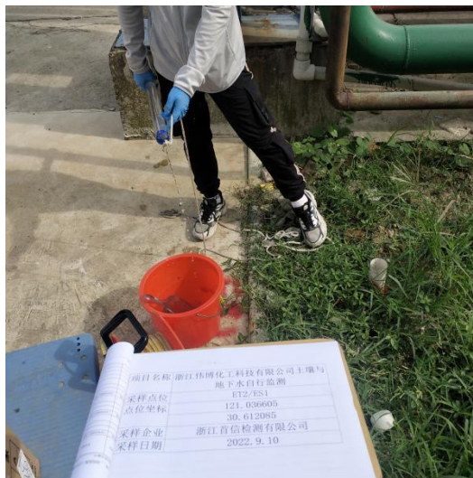
照片2： 现场洗井
