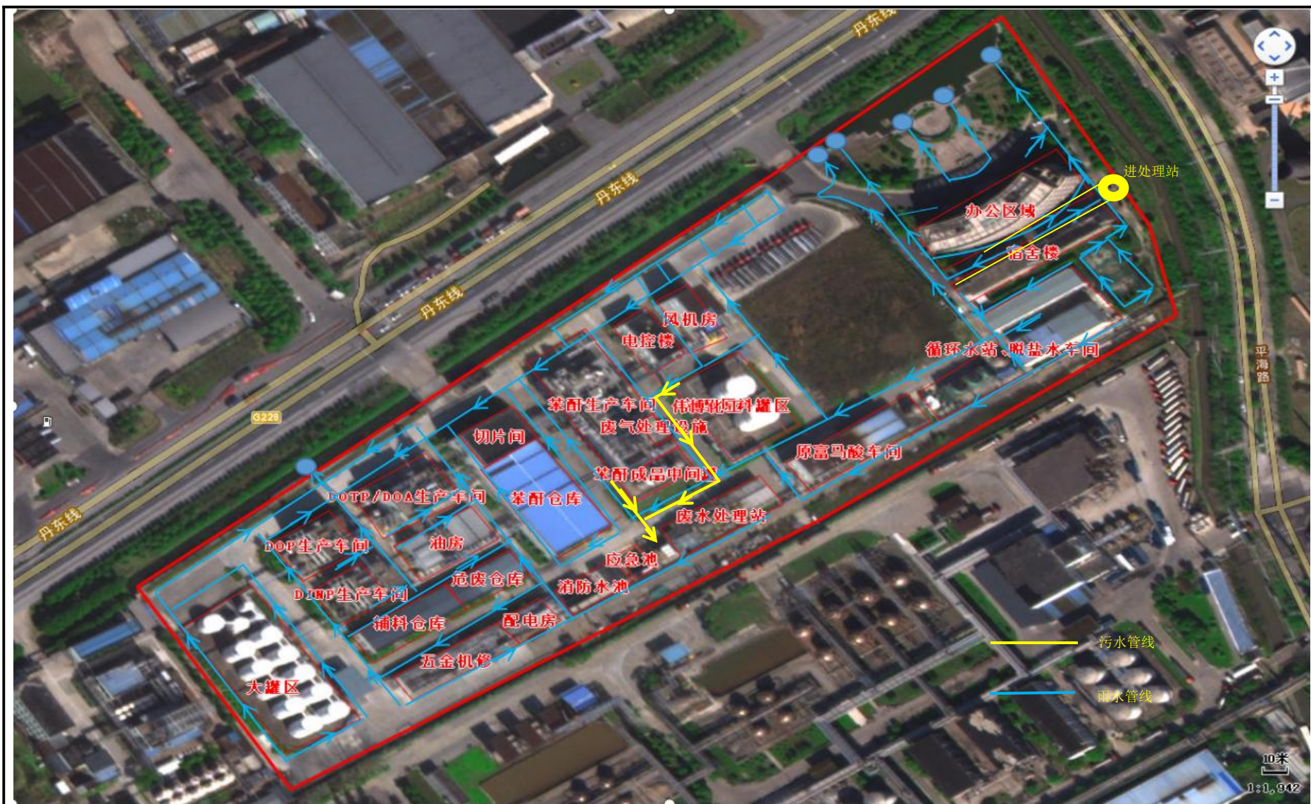
图4.2-3 厂区内雨污水管网示意图
