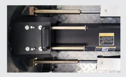
双射油缸平衡布置,确保射嘴对中精准。采用双射移结构,能使座台平稳而均衡有力的顶住模具进胶口,注射稳定,密封性好,有效避免漏胶。
