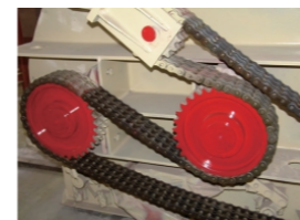
SSHJ高效混合机工作示意图
