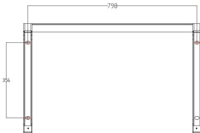
Rys. 4.4 Wymiary wspornika montażowego
