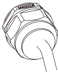
Rys. 5.11 Dokręcić skrzynkę przyłączeniową AC
