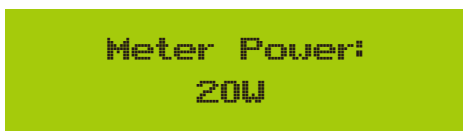
Abb. 7.36 Null-Export-Funktion über Energiezähler einschalten
