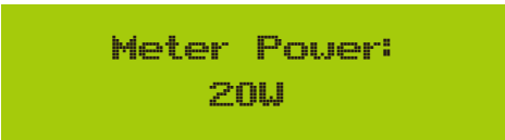
Abb. 7.36 Null-Export-Funktion über Energiezähler einschalten
