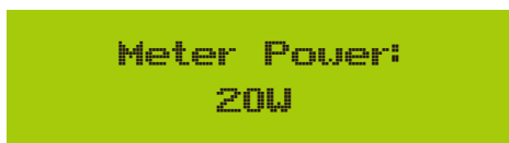
Abb. 7.36 Null-Export-Funktion über Energiezähler einschalten
