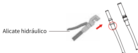
Foto 5.4 Crimpar o pino de contato ao fio
